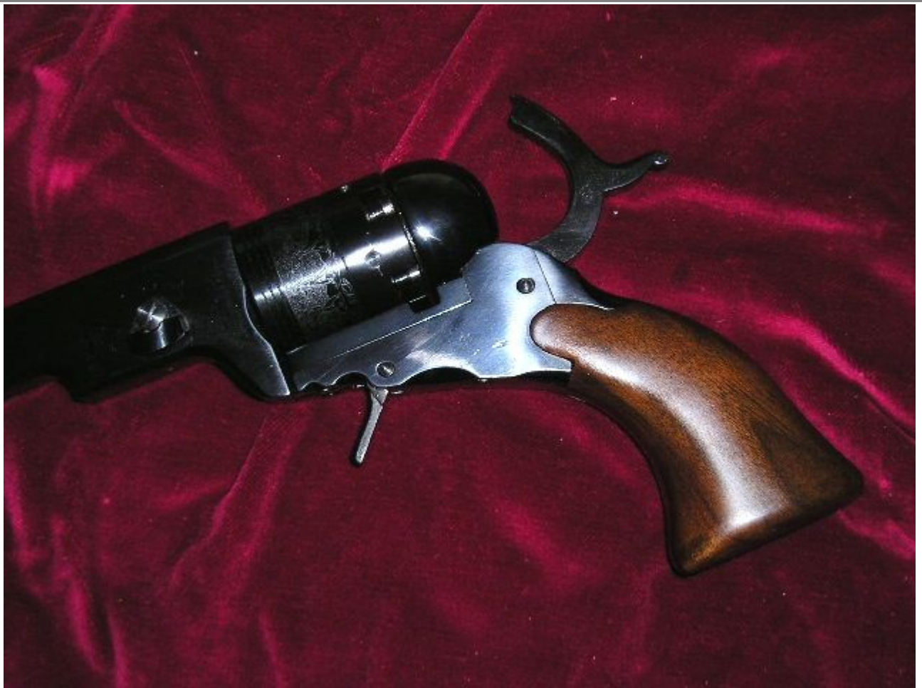
Figura 5: Armando il cane, appare il grilletto nella parte inferiore del castello.
