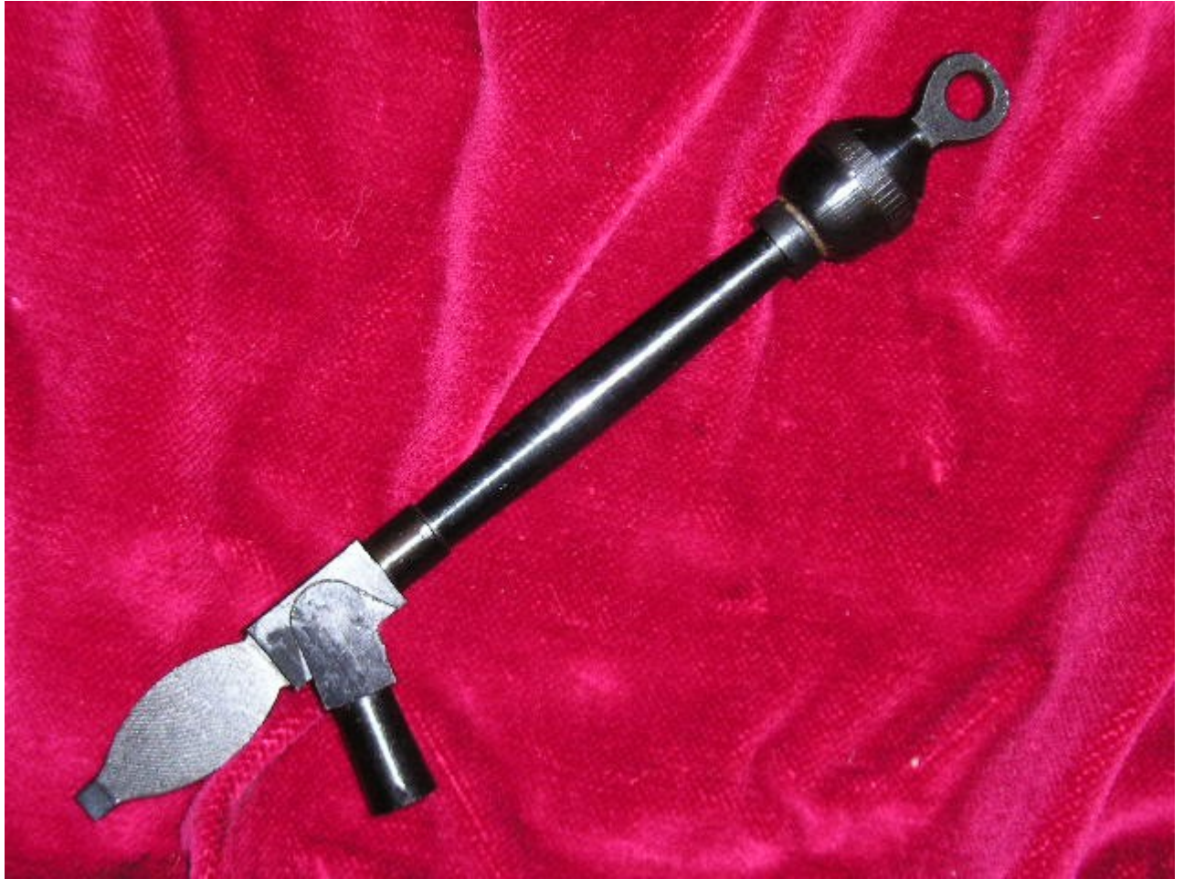
Figura 9 e 9bis: Per caricare l'arma si utilizzava un braccio con testa a lancetta infilato nella sede della chiavetta di ritegno della canna ma estremamente scomodo da utilizzare.
