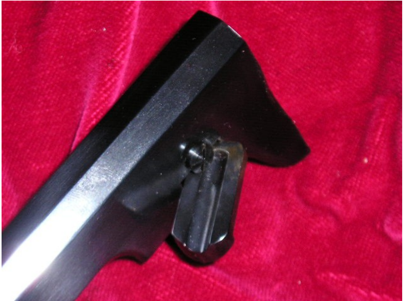
Figura 6: Nella Paterson la chiavetta di ritegno della canna è vincolata tramite una vite.
