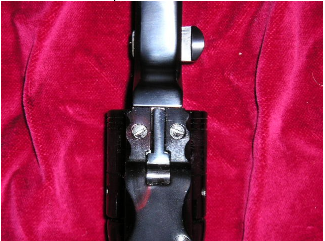
Figura 7 e 7bis:Il castello visto dalla parte inferiore, con il grilletto in posizione di chiusura.
